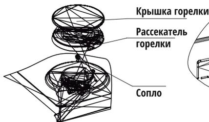
Рис. 14. Замена сопла горелки гриля
