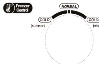
В «БОЛЕЕ ХОЛОДНОМ» положении («COLDER») температура замерзания – относительно низкая, в то время как температура замерзания в «ХОЛОДНОМ» положении («COLD») – относительно высокая, поэтому обычно используется «НОРМАЛЬНОЕ» положение («NORMAL»).
