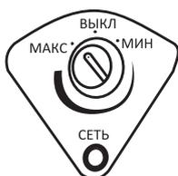
**Панель управления для моделей ZCF 110W, ZCF 170W, ZCF 210W** представлена ручкой термостата и индикатором зеленого цвета. Зеленый индикатор на панели управления означает, что ларь включен в сеть.
