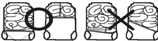
**⚠ Внимание!** В случае деформации барабана центрифуги или бака центрифуги из-за неправильной укладки белья в барабан центрифуги, изделие снимается с гарантийного ремонта и ремонтируется за счёт владельца.
