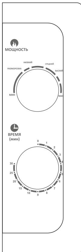
Панель управления состоит из двух функциональных переключателей. Одним из них является ручка регулирования времени приготовления (Таймер), а другой регулятор мощности.
